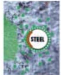
MCI が鉄筋を保護し、錆の進行を止める
