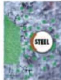
モルタルに混入した MCI がコンクリートを通して浸透する
